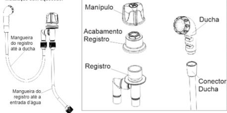
Instalação sem aquecedor
